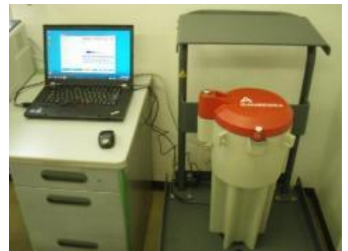
食品放射能測定システム
